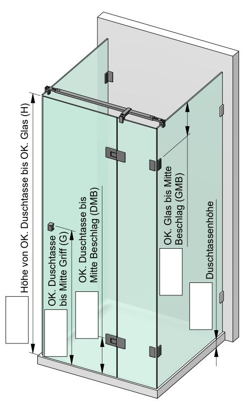
Die hier dargestellte Verwendung von Stabilisationsstangen ist als Beispiel anzusehen. Größe und Position der Stabilisationsstangen ist abhänging von der Glasgröße!
