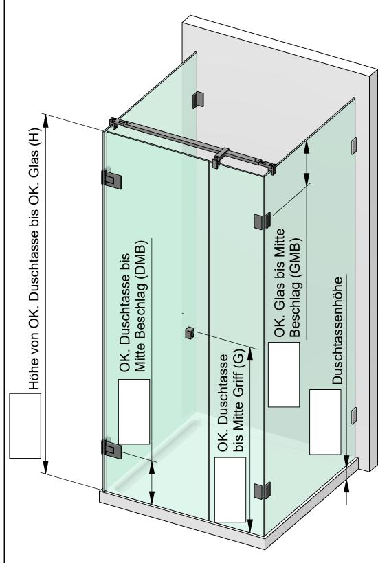
Die hier dargestellte Verwendung von Stabilisationsstangen ist als Beispiel anzusehen. Größe und Position der Stabilisationsstangen ist abhänging von der Glasgröße!
