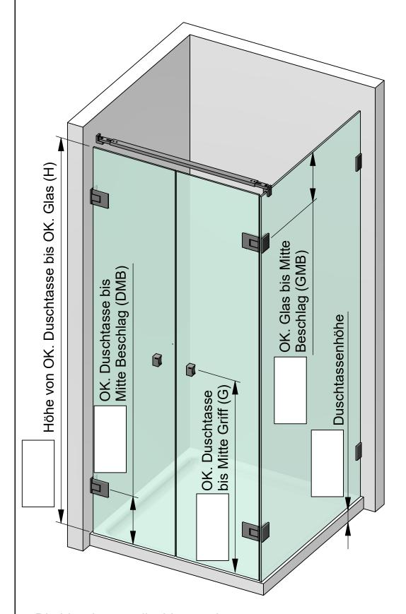
Die hier dargestellte Verwendung von Stabilisationsstangen ist als Beispiel anzusehen. Größe und Position der Stabilisationsstangen ist abhänging von der Glasgröße!
