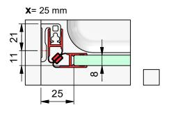
c) mit Dichtprofil 8855KU0-8 und Türanschlag-Trägerprofil 8880
