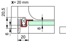
d) mit Dichtprofil 8861KU0-8 und Türanschlag-Trägerprofil 8880
