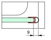
b) mit Dichtprofil 8851KU0-8 und Türanschlag-Trägerprofil 8880
