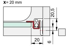
d) mit Dichtprofil 8861KU0-8 und Türanschlag-Trägerprofil 8880
