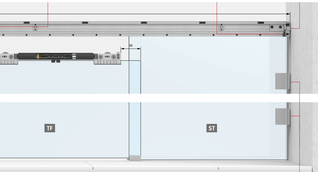
Türanschlag in der Laufschiene door-stop in the guide rail Art.-Nr.: | art no.: 8822ZN_-EA
