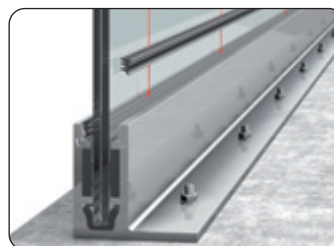
6. Mise en place du joint haut
