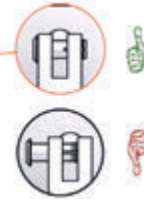
Montageschritt Spreizbolzen 1910-7VA (22mm) im unteren Wandhalter 1779VA Montageschritt Spreizbolzen 1910-7VA (22mm) im unteren Wandhalter 1779VA
