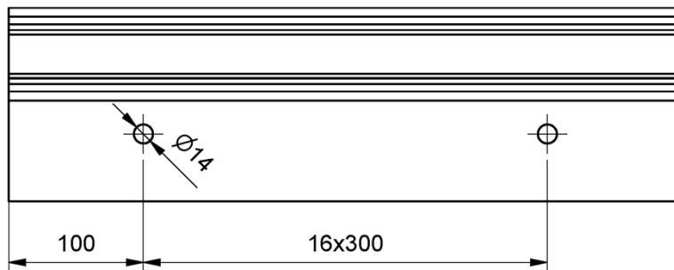
Bohrungsabstand bei Profillänge 5000mm
