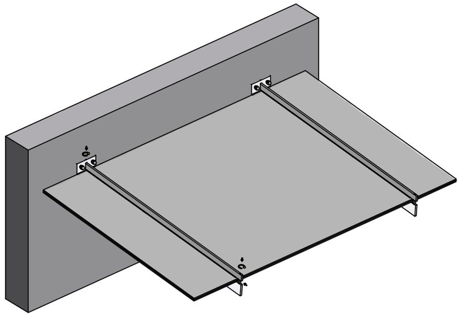
Beim Bohrvorgang der Anschraublöcher zur Wandmontage, muß eine horizontale Ausrichtung der Gewindefestigungen zueinander gewährleistet sein.
