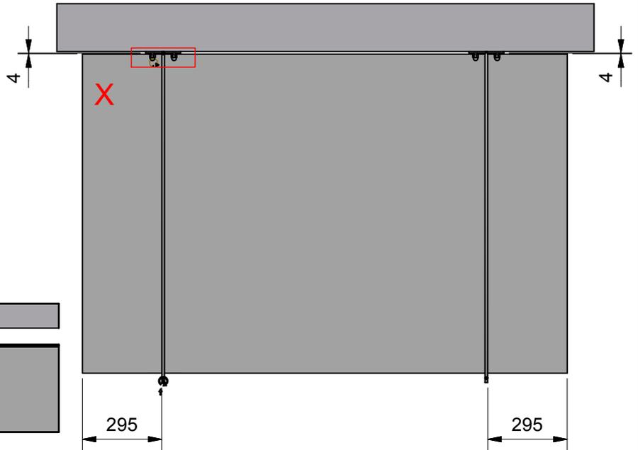
Die Befestigungsschrauben soweit hineinschrauben, bis es zu einem Kontakt zwischen oberer Deckleiste und Glasscheibe kommt. Im weiteren Verlauf, die Schrauben nur noch soweit anziehen, das die obere Deckleiste sich in ihrer Form (Bogen im mittleren Bereich) nicht verbiegt.
